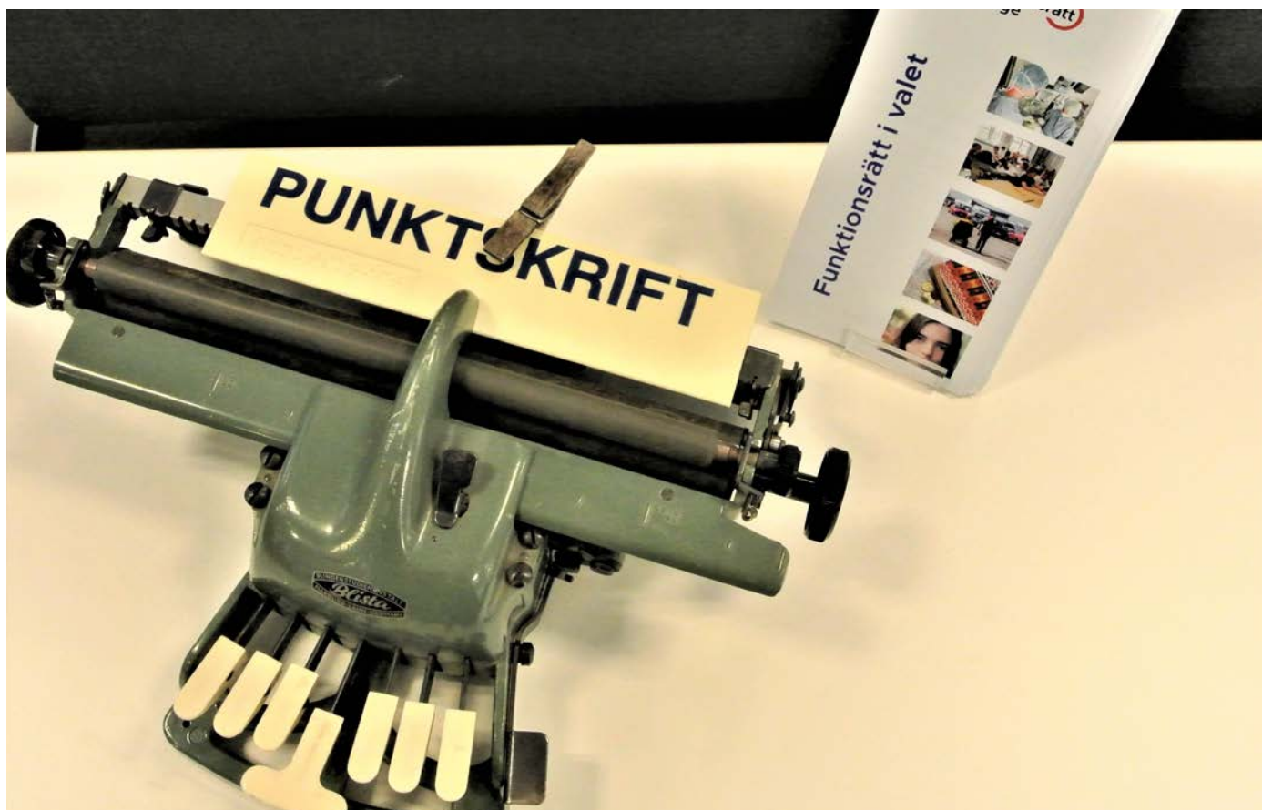
Punktskrift består av sex upphöjda punkter. Skriften läses genom att känna på punkterna med fingertopparna. Punktskriftsmaskinen har en tangent för varje punkt i punktskriftscellen.
